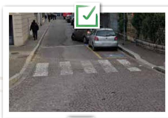
*Nel caso sopra un esempio positivo di accessibilità: attraversamento pedonale con marciapiedi ben raccordati con sede stradale. A Como via Milano angolo via Rezia.*
