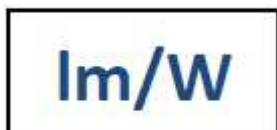
L'efficienza energetica delle lampadine si determina mettendo in relazione la quantità di luce emessa (lumen) e la potenza assorbita dalla lampadina (Watt); maggiore è la quantità di lumen emessi per ogni Watt consumato, maggiore è l'efficienza energetica della lampadina (consumi più ridotti).
