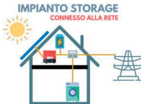
*Impianto fotovoltaico storage connesso alla rete: elementi caratteristici (campo fotovoltaico, inverter, accumulatore, contatore, utilizzatore, rete elettrica)*
